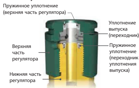
Рисунок 29. Верхний узел регулятора (49MV22/72)
