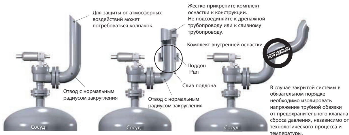
Рисунок 10. Выравнивание деталей POSRV
