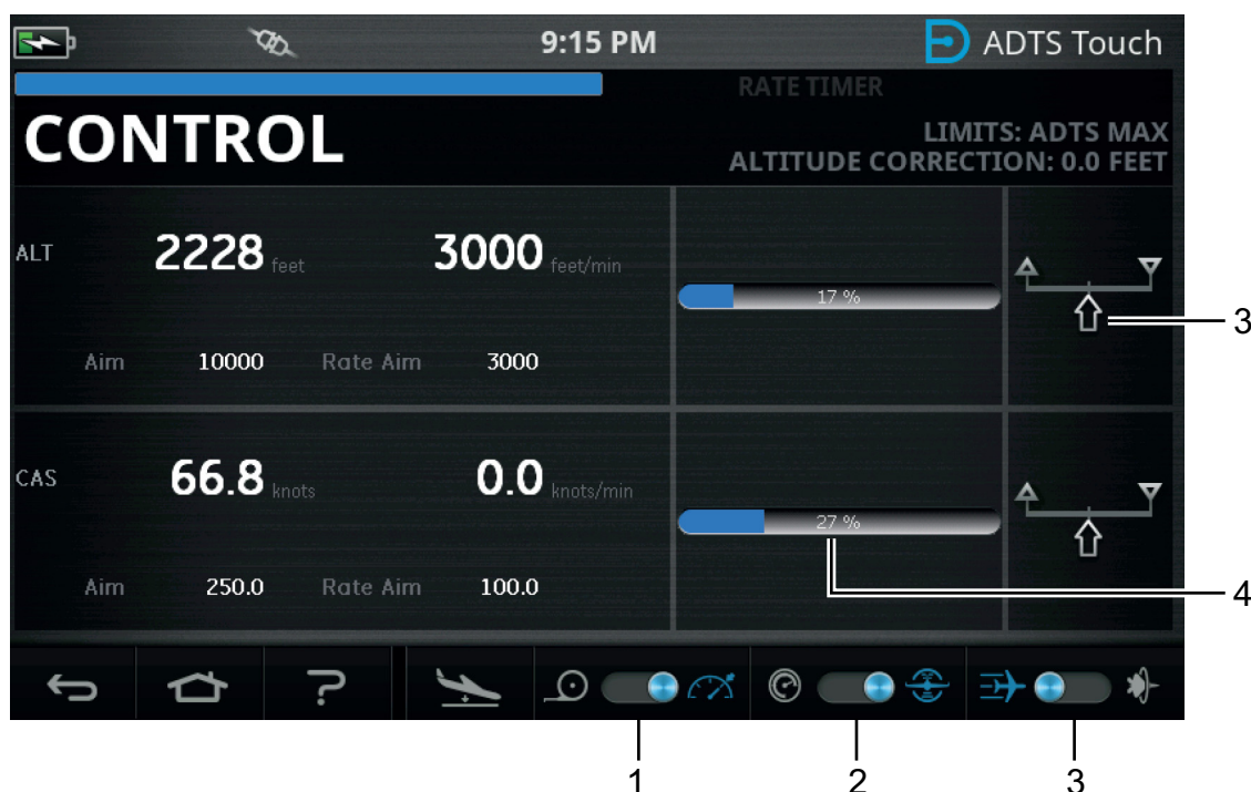
Рисунок 3-7: Режим управления — одноканальный режим
