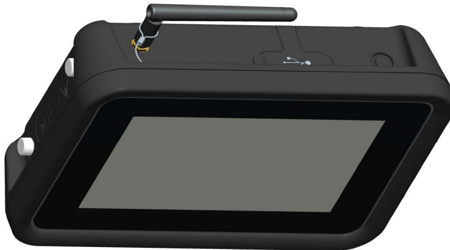
Рисунок 3-58: ADTSTOUCH-ER с внешней Bluetooth-антенной®
