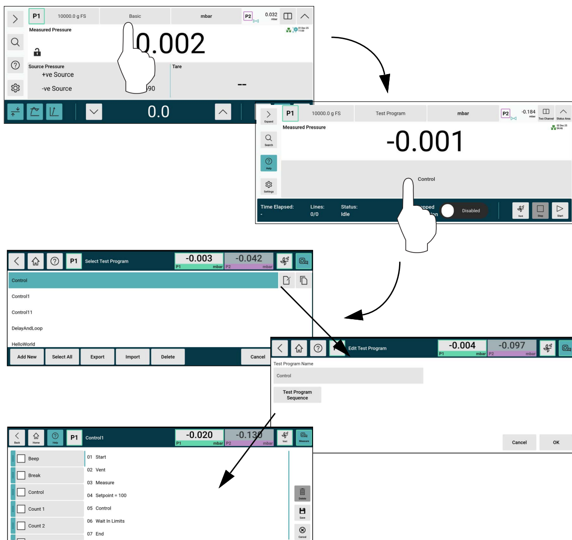
Figure 4-11 : Mise en place du programme de test
