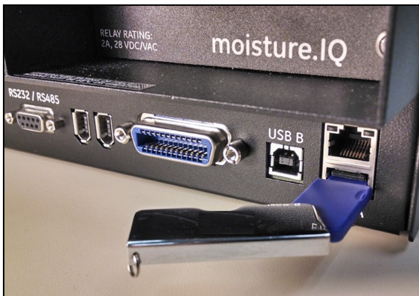
Figura 84: Unidade Flash USB conectada na parte posterior do chassi
