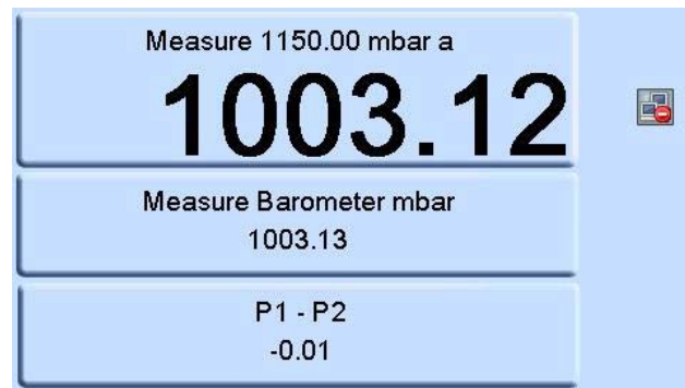
Abbildung 3-18: Funktionsbereich so eingestellt, dass P1-P2 angezeigt wird
