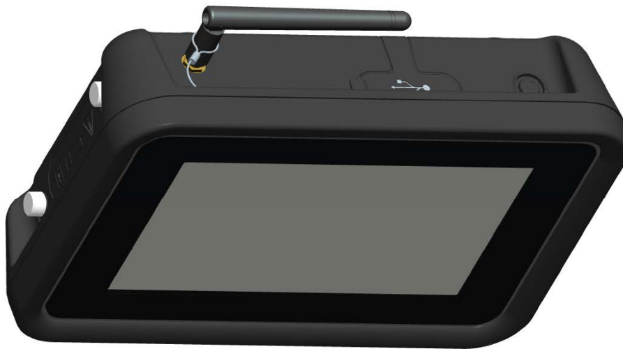
图 3-58: ADTSTOUCH-ER 配备外部蓝牙® 天线
