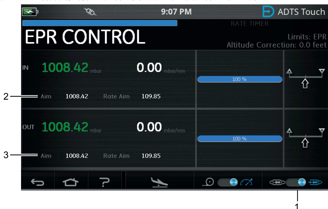
图 3-33：EPR 控制屏幕（方法 2）
