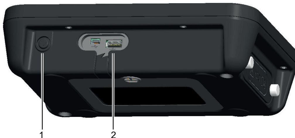
Figura 5-3: ADTSTOUCH Pulsante di accensione e porta USB
