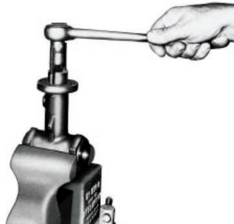
Рисунок 4 - Затяжка фиксатора кольца седла (4)
