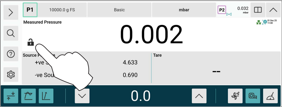
Figura 3-22: Controles de Trava
